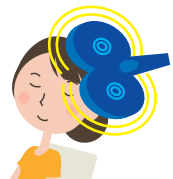
8の字型のコイルに電流を流し、磁界を発生させます。
